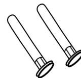
※90°ストップピンを取り付け時には、冷凍庫上段の引出しは外せなくなります。
