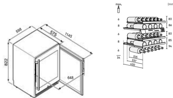
\* ボルドータイプのワインボトル 0.75l - (H: 300.5 mm, Ø 76.1 mm)
