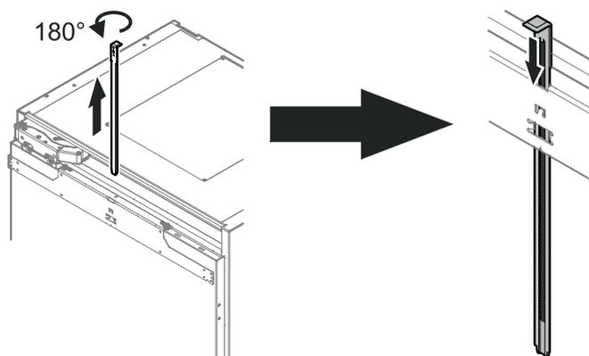
ガイドレールを上部固定金具から外して180° 回し、上部固定金具に下端まで差し込み直します。
