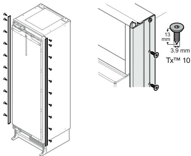
側面隙間用カバーを機器本体のフレームの端に左右取り付け、機器の上端に位置を合わせて、ねじで留めます。カバーは透明なので、取付穴の位置は目視で確認できますが、カバーに事前に下穴を開けておくことを推奨します。
