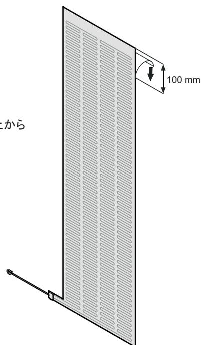
7. 右側の機器の左側面に側面ヒーターを貼り付けてください。側面ヒーターの上端は本体フレームの上端から63mm下がった位置、前面は本体フレームの前面端から32mm奥の位置に貼り付けてください。保護フィルムをはがしながら、側面ヒーターを少しずつ貼り付けていってください。
