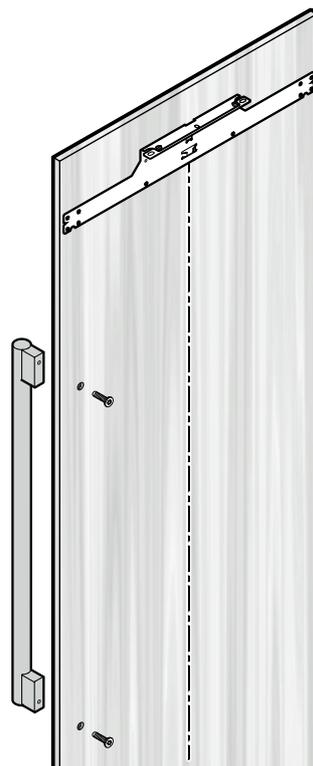
取付穴は皿穴で加工して、ドアハンドルの取付には皿ねじを使用してください。ねじ頭はドア面材の面に合わせてください。
