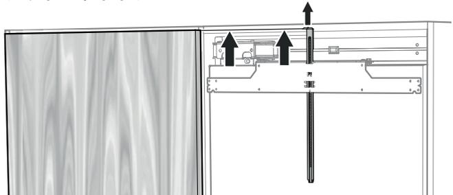
ドアを開けて、ガイドレールを付けたままの状態、上部固定金具を外してください。
