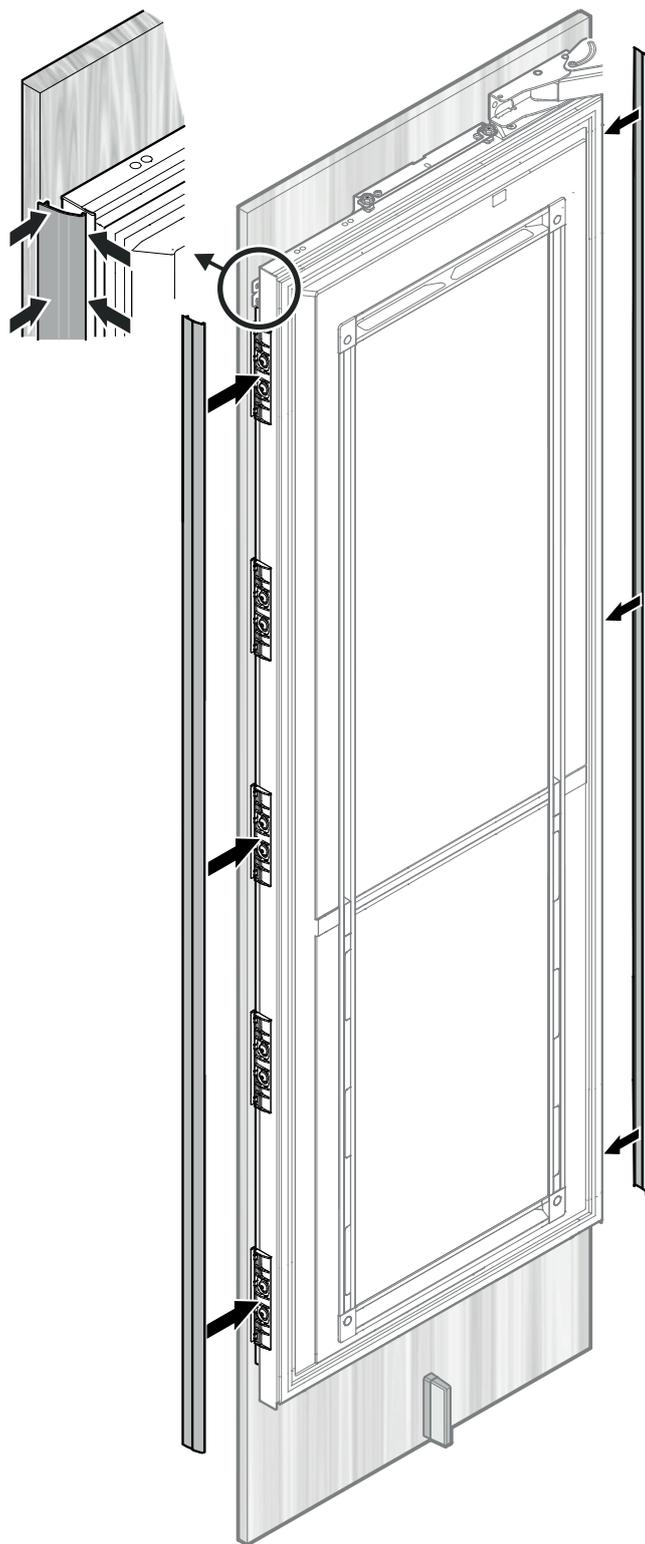
幅木材の板厚に合わせて、取付ブラケットの位置を調整してください。
