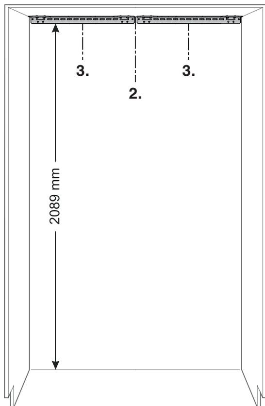
2. 設置開口の奥壁面に開口のセンターラインをマークしてください。
