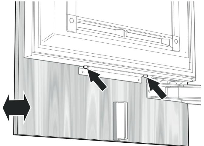
上部固定金具の長穴を使って、ドア面材の横方向の位置を合わせてください。
