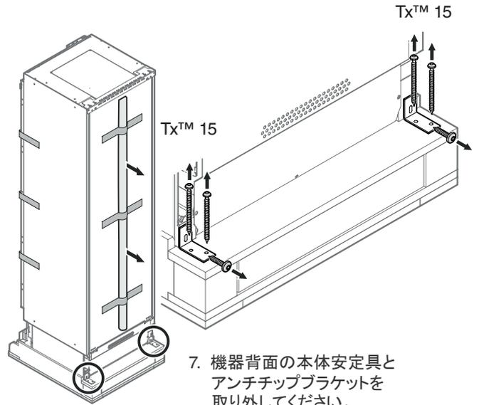
7. 機器背面の本体安定具とアンチチップブラケットを取り外してください。
