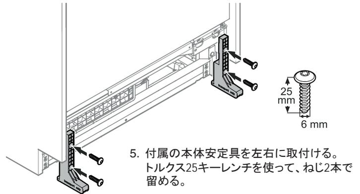
5. 付属の本体安定具を左右に取付ける。トルクス25キーレンチを使って、ねじ2本で留める。
