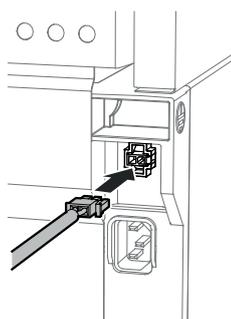
9. 側面ヒーターの電源端子をソケットに接続してください。
