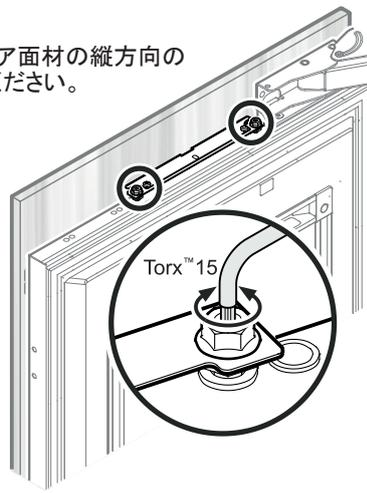
六角ナットを緩めて、調整ねじを回してください。トルクス15キーレンチが付属品に含まれています。
