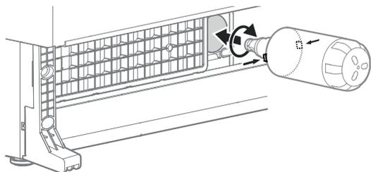
ウォーターフィルターを前方の突起がはまる位置まで差し込み、時計回りに回してはめ込みます。
