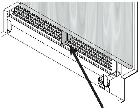
ベンチレーショングリルのスペーサーとドア面材側のスペーサーの間に大きな隙間がないか確認してください。
