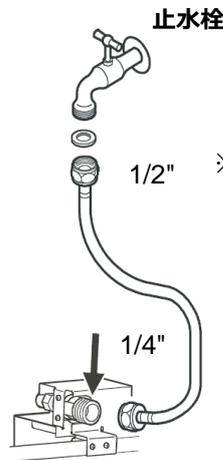
※機器接続口には付属の異径ブッシングを使用して、接続してください。
