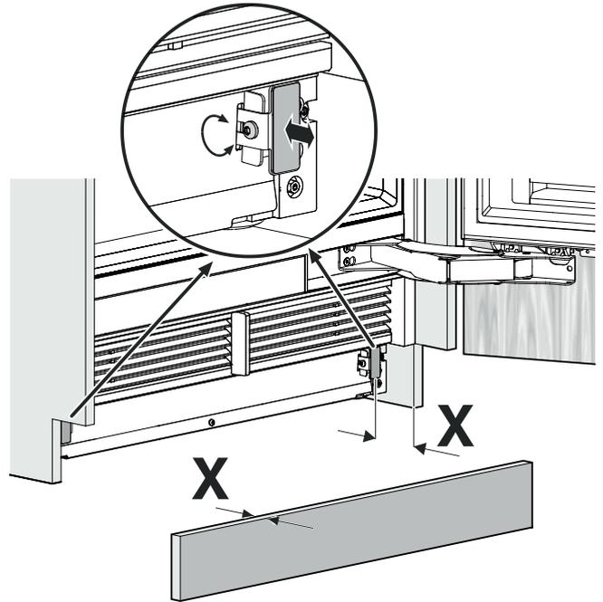
粘着シールの保護フィルムをはがして、幅木材を貼り付けてください。
