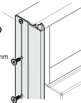
15. 側面隙間用カバーを機器本体のフレームの端に左右取り付け、機器の上端に位置を合わせて、ねじで留めます。カバーは透明なので、取付穴の位置は目視で確認できますが、カバーに事前に下穴を開けておくことを推奨します。
