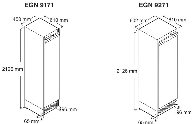
記載の高さ寸法は高さ調整機構が下限時の高さ寸法です。
